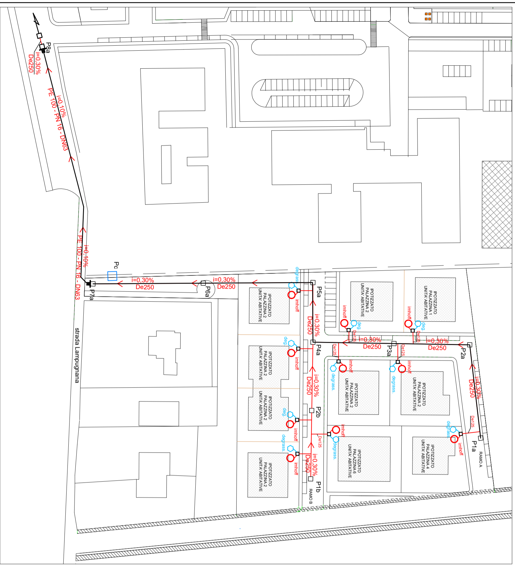
PLANIMETRIA RETE ACQUE REFLUE NUOVA LOTTIZZAZIONE scala 1:500
