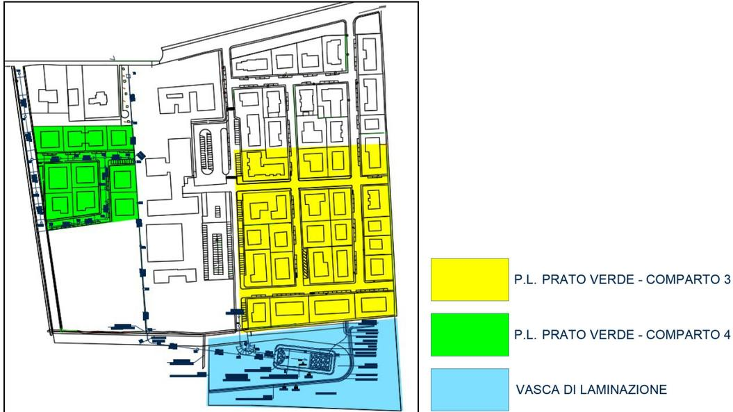
Figura 60. Posizione della vasca di laminazione rispetto ai due comparti del piano attuativo
