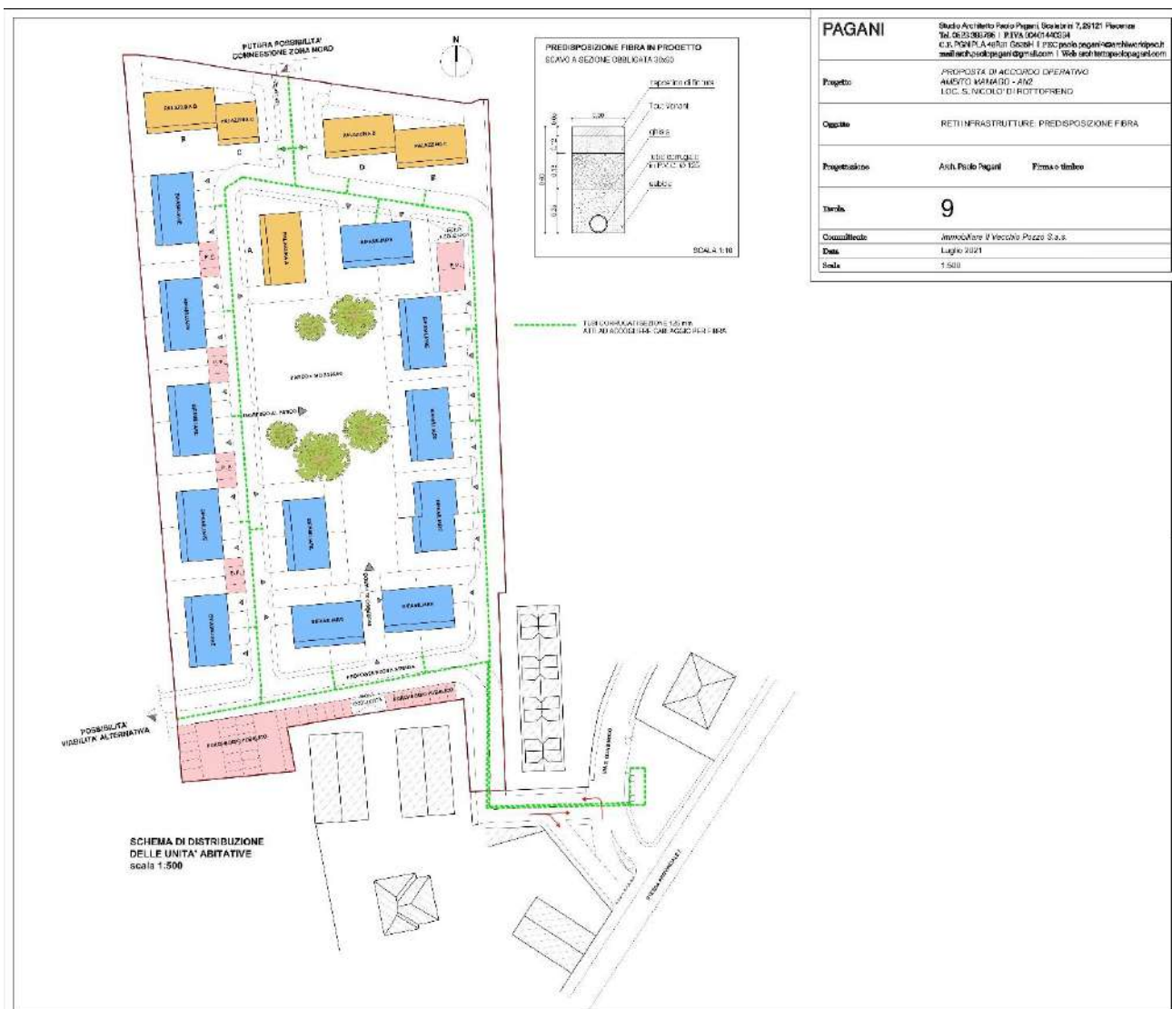
Fig. 7: Planimetria di progetto reti infrastrutture e fibra (Progettazione, Dott. Arch. Paolo Pagani)
