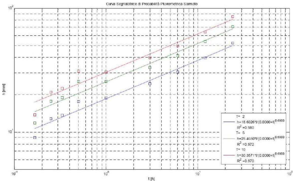
Fig. n°4: Curve di Possibilità Pluviometrica calcolata per la stazione di Sarmato
